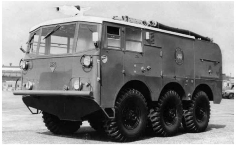
Een G19 van de Royal Canadian Air Force. Het voertuig heeft nog de oorspronkelijke dakmonitor van Pyrene. De vrijgekomen ruimte van de CBM slangen werd gebruikt voor de kachel van de cabineverwarming.
